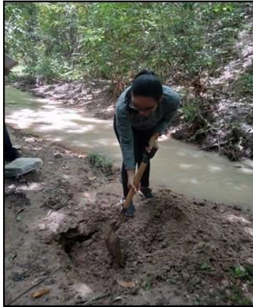
Figura 4.2 Apertura de calicatas.
