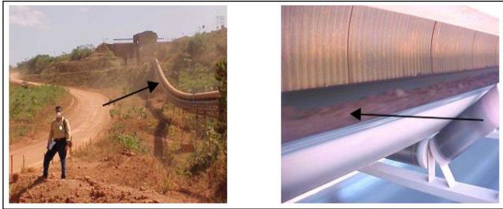
Figura 5.9 Correa transportadora del mineral de bauxita (correa de bajada).
