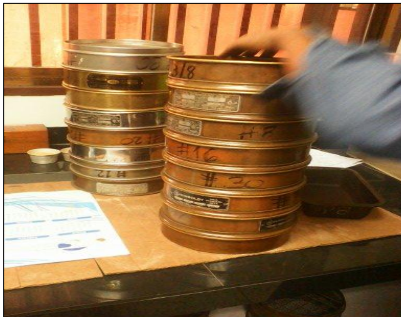
Figura A.4 Cedazos de ensayo.
