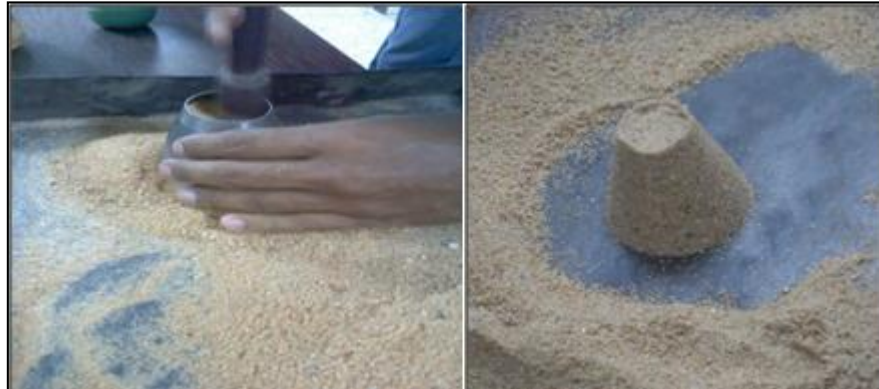
Figura 4.8 Compactado y desmoldado de la arena.
