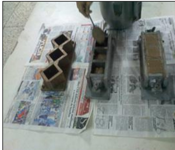
Figura 4.25 Vaciado del mortero.
