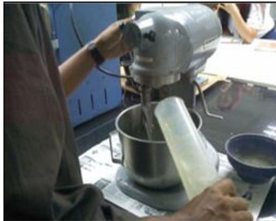
Figura 4.17 Añadiendo el agua a la mezcla.
