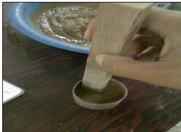
Figura 4.22 Llenado y compactado del mortero.
