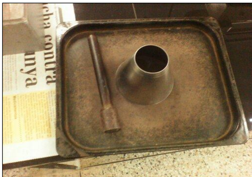
Figura A.6 Barra compactadora y cilindro tronco-cónico.
