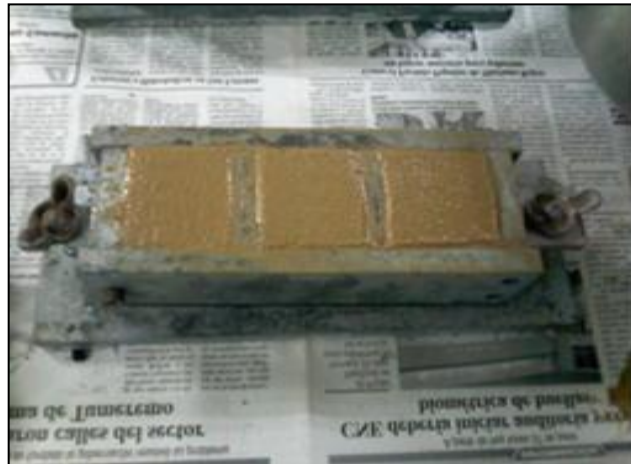
Figura 4.27 Enrasado del mortero en los moldes.
