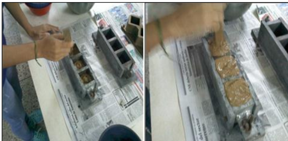
Figura 4.26 Compactado de la primera y segunda capa de mortero.
