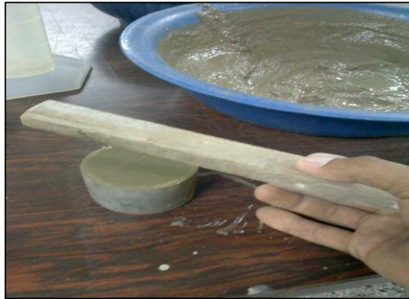
Figura 4.23 Alisado y limpiado el sobrante del mortero.
