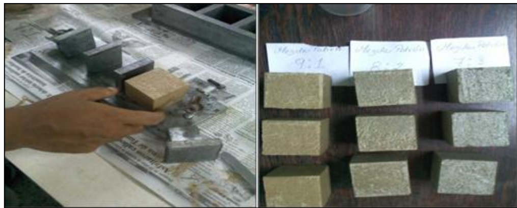
Figura 4.28 Desencofrado de las probetas.
