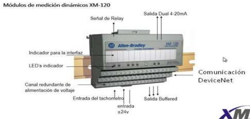
**Figura 17: Módulo de medición dinámica XM-120**
