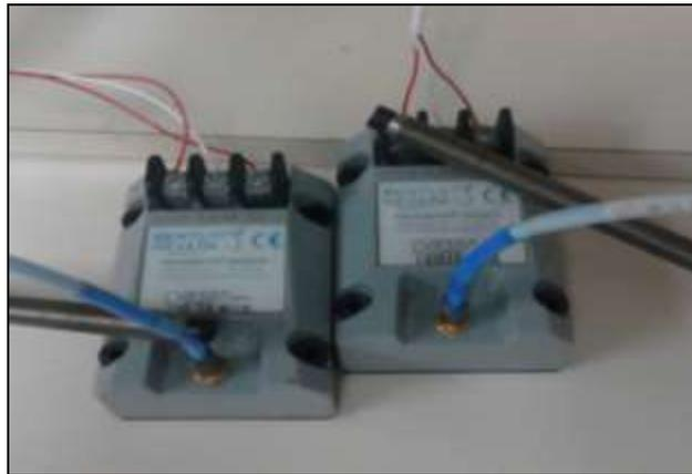
**Figura 15: Proximito conectado al transductor**
