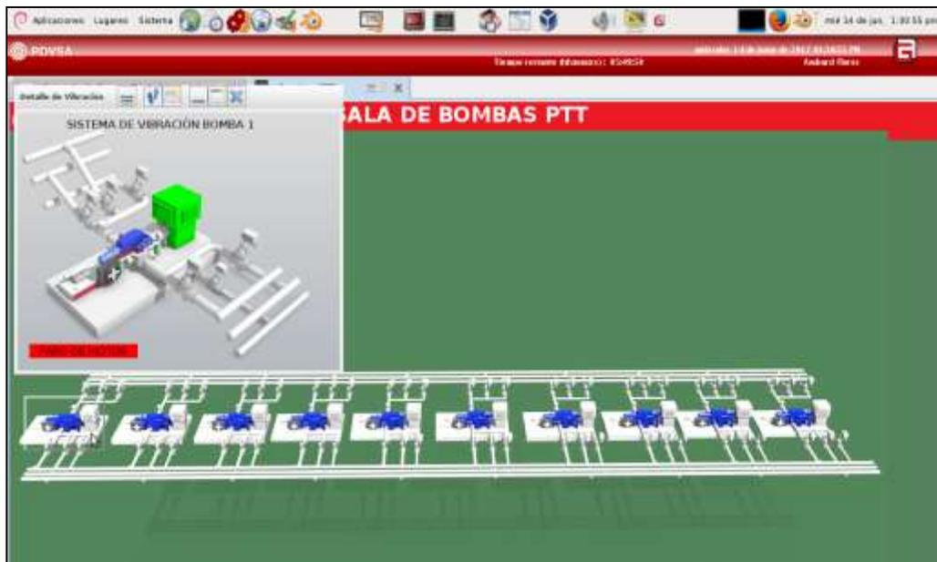
**Figura 45: Bomba 1 indicando un paro por vibración**
