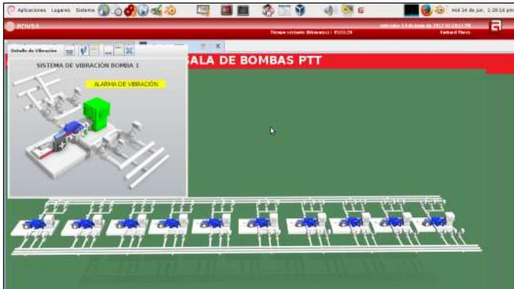
**Figura 44: Bomba 1 indicando una alarma de vibración**
