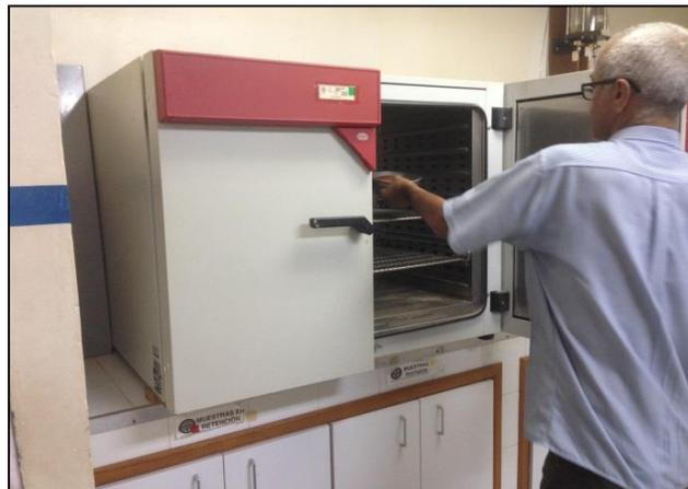
Figura 4.1 Horno utilizado para secar la muestra.
