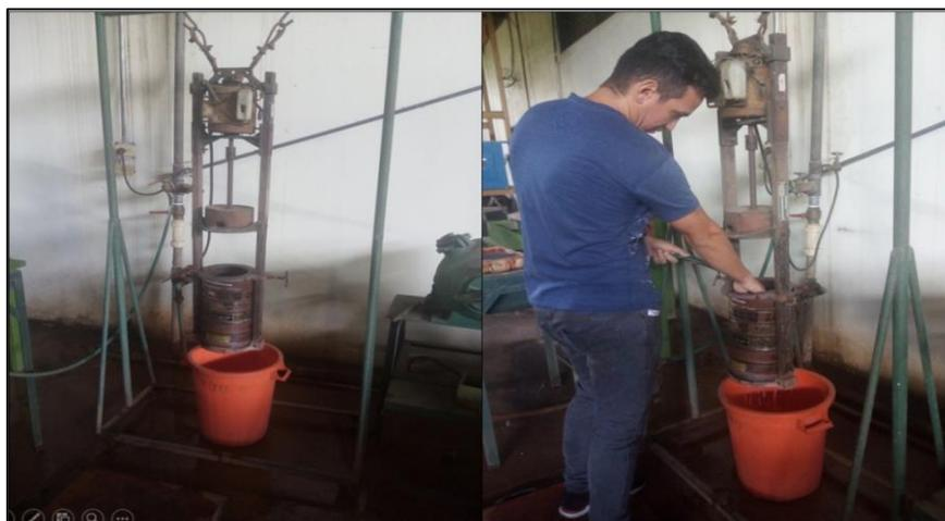
Figura 4.4 Máquina tamizadora (izquierda) y lavado de muestras durante tamizado (derecha)
