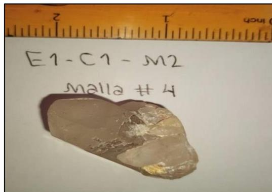
Figura 5.23 Muestra de cuarzo en macla de contacto con sistema cristalino hexagonal
