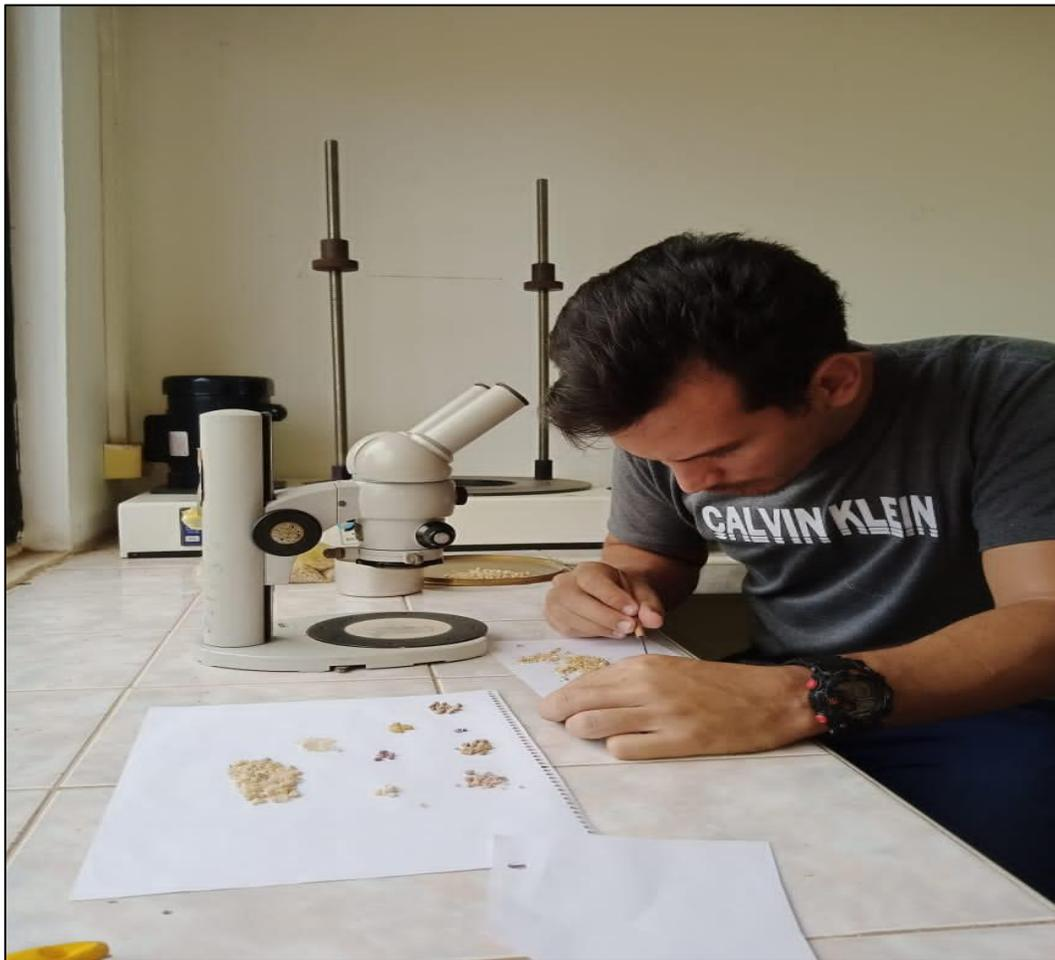
Figura 4.5 Observación con lupa estereográfica y separación de minerales en base a sus propiedades físicas (color y textura)
