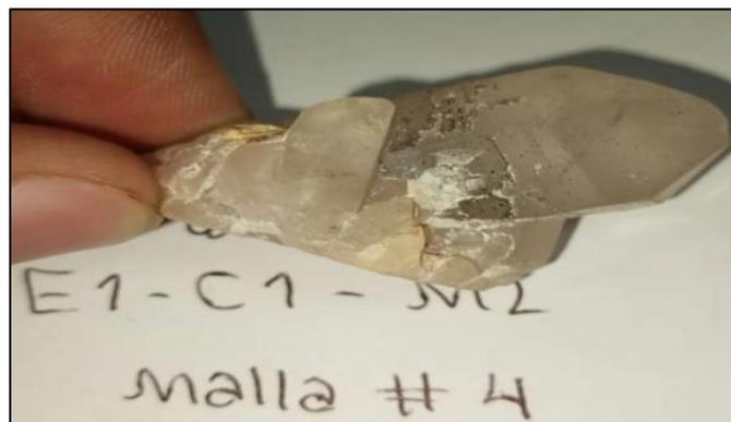
Figura 5.24 Fotografía detallada de muestra donde se observa la macla de contacto
