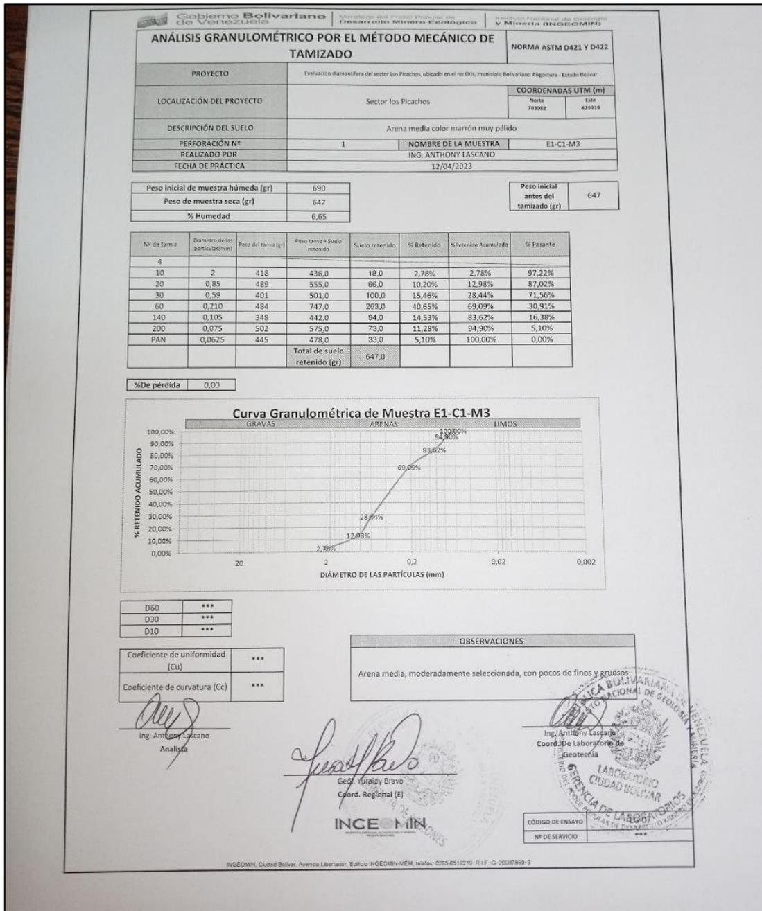
**A.2 Análisis granulométrico de la muestra E1-C1-M3**
