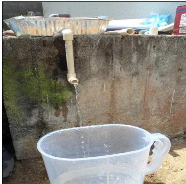
A.4. Ejemplo de sistema 1 de drenaje utilizado para realizar los experimentos.
