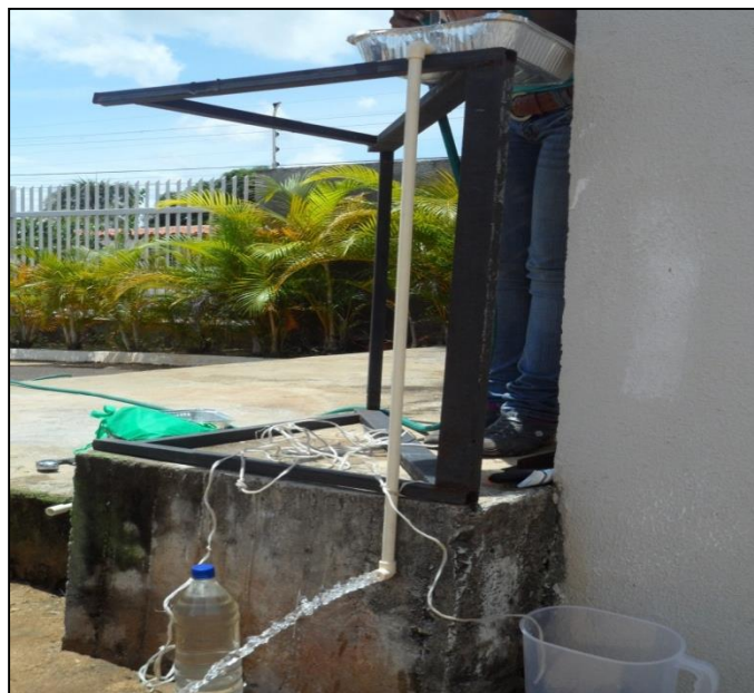
Anexo 6. Ejemplo de sistema 11 de drenaje utilizado para realizar los experimentos
