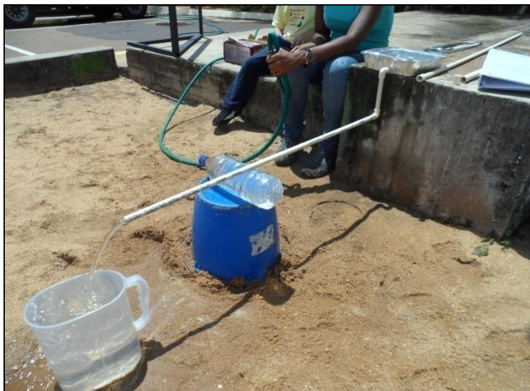
A. 5. Ejemplo de sistema 9 de drenaje utilizado para realizar los experimentos
