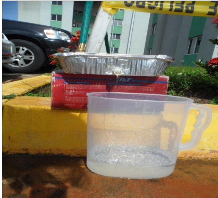
A.1. Materiales utilizados para realizar el experimento con el orificio para diámetro de \frac{1}{2} " y \frac{3}{4} ".
