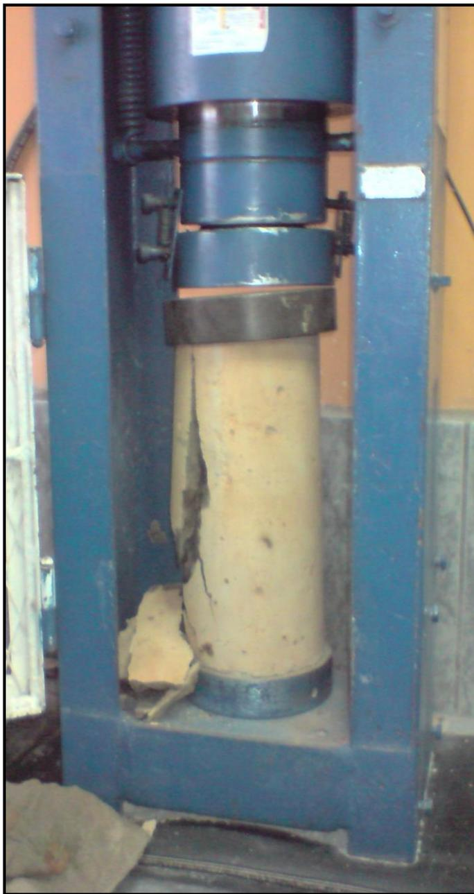
C.1 Muestra cilíndrica de concreto después de aplicada la carga máxima a los 28 días.
