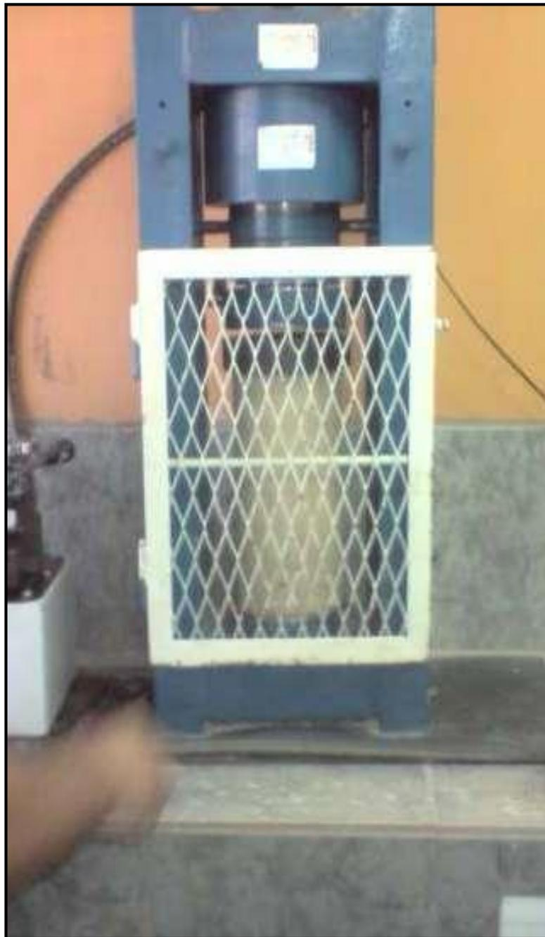
A.1 Colocación del cilindro de concreto en la prensa.
