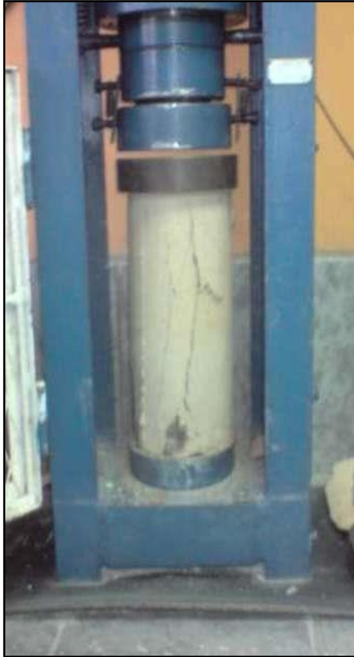
A.3 Cilindro después de aplicada la carga.
