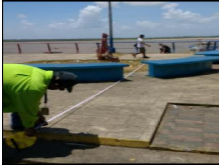
Figura 5.23 Medición con cinta de las caminerías sobre el malecón.
