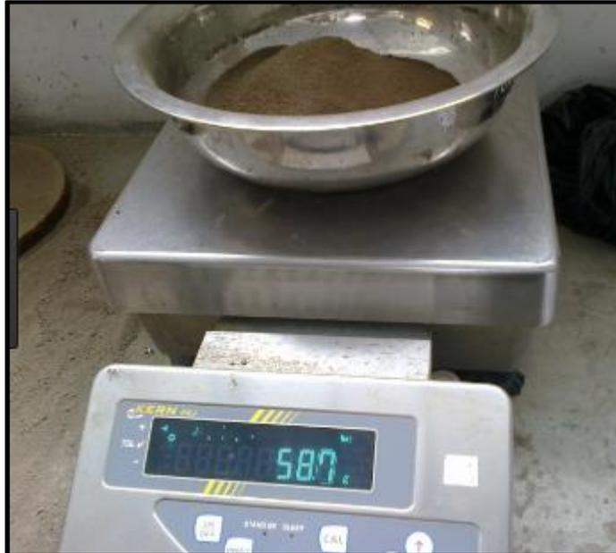
Figura 5.16 Proceso de pesaje de suelo retenido en análisis granulométrico de las muestras
