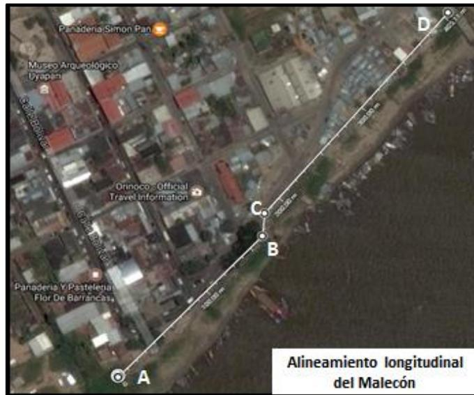
Figura 5.32 Alineamiento del eje longitudinal del malecón.
