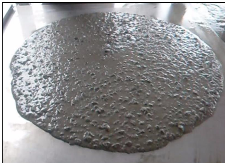
Figura J.5. Ecurrimiento inicial del CAN.
