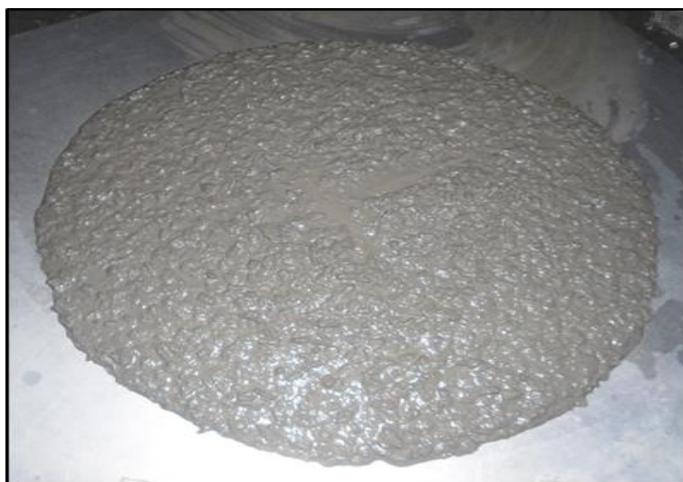
Figura J.6. Ecurrimiento una hora despues del CAN.
