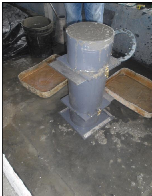
Figura J.4. Columna de segregación.
