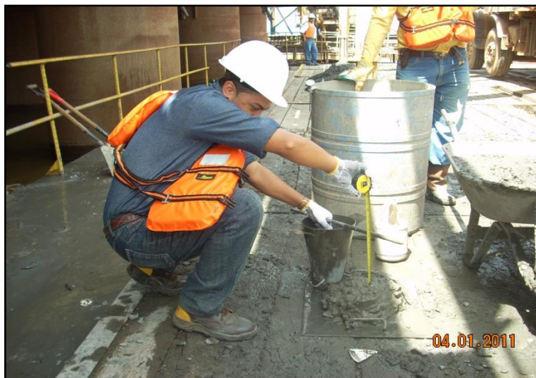
Figura J.9. Ensayo de asentamiento.
