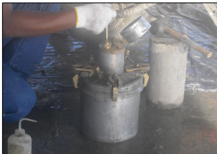
Figura J.8. Ensayo de contenido de aire.
