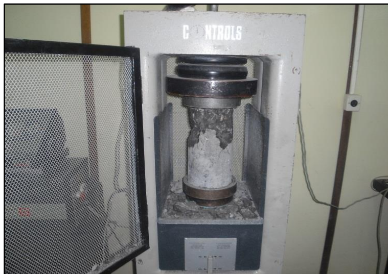
Figura J.7. Ruptura de cilindro.
