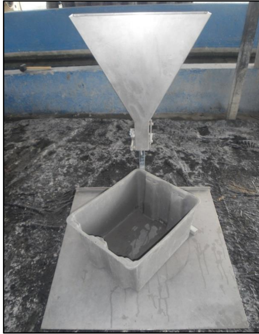
Figura J.1. Embudo V.
