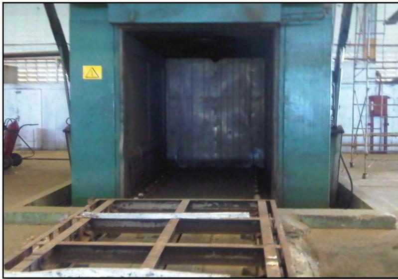
Figura 5.1 Horno de tratamiento térmico TKF
