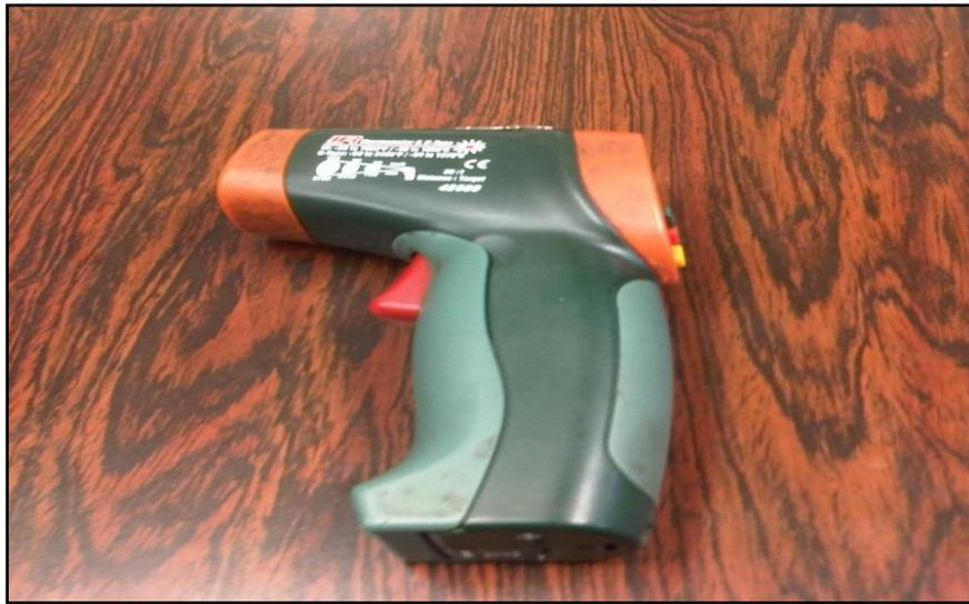
Figura 5.20 Termómetro infrarrojo PCE-889 utilizado para las mediciones
