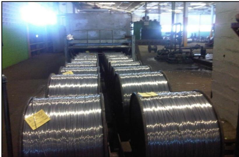
Figura 5.2 Entrada de las bobinas al horno de tratamiento térmico Lanly
