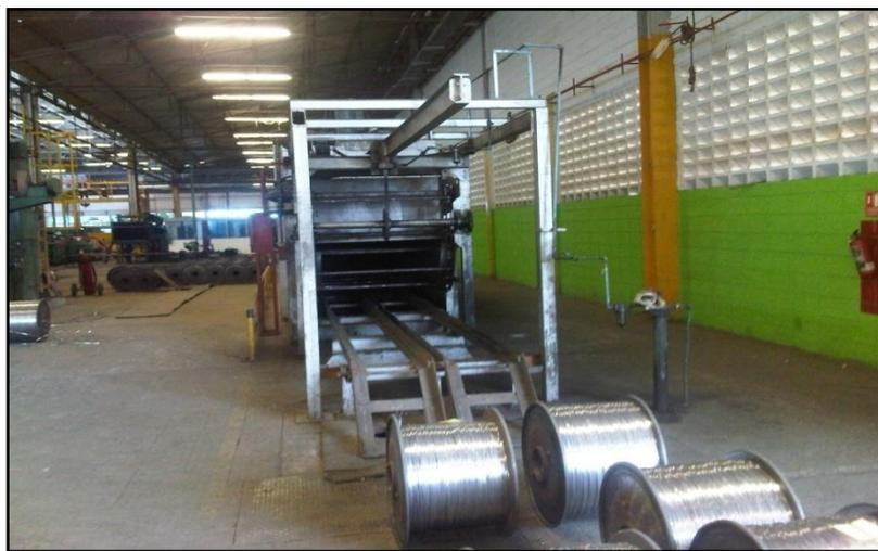
Figura 5.3 Salida de las bobinas del horno de tratamiento térmico Lanly
