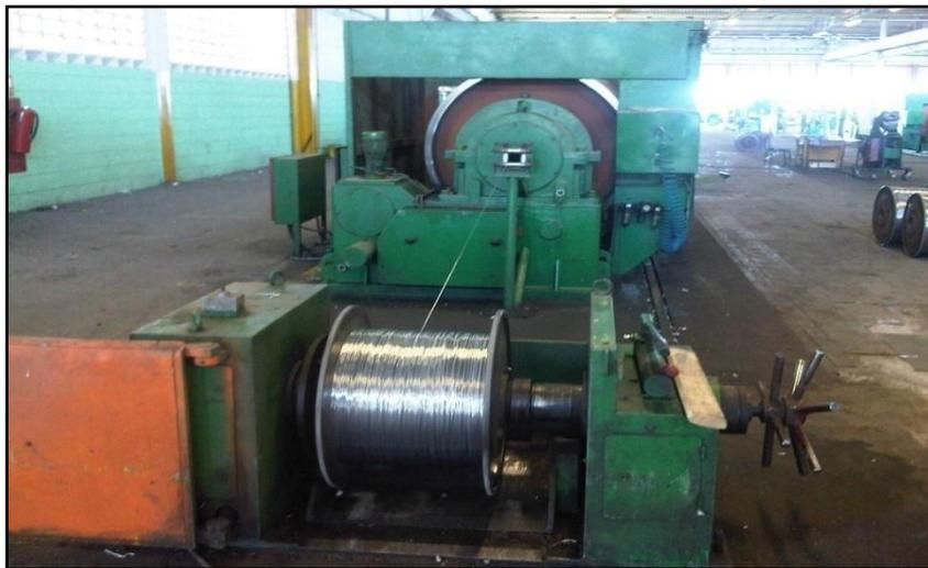
Figura 5.6 Carga de las máquinas cableadoras
