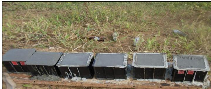
Figura 5.5 Toma de muestra de concreto. (Barroso R., y Bolívar M., 2016)
