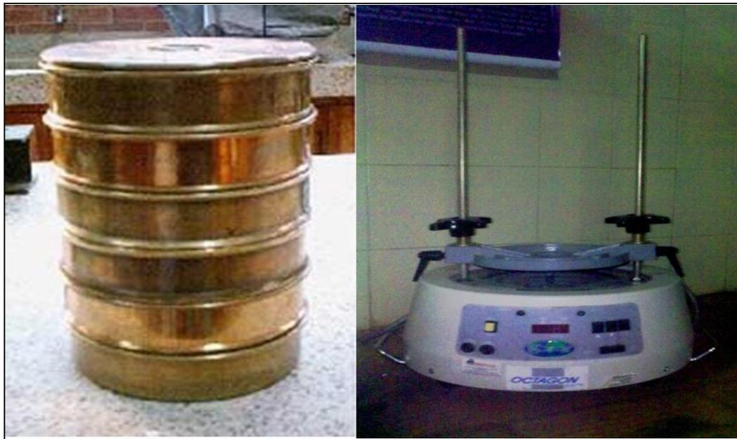
Figura 4.20 Tamices y agitador de tamiz empleados en el Laboratorio de Sedimentología (UDO Bolívar, 2012).
