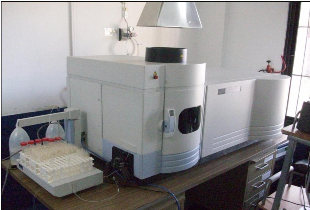
Figura 4.2 Espectrómetro de emisión atómica con plasma inductivamente acoplado, INGEOMIN 2010.
