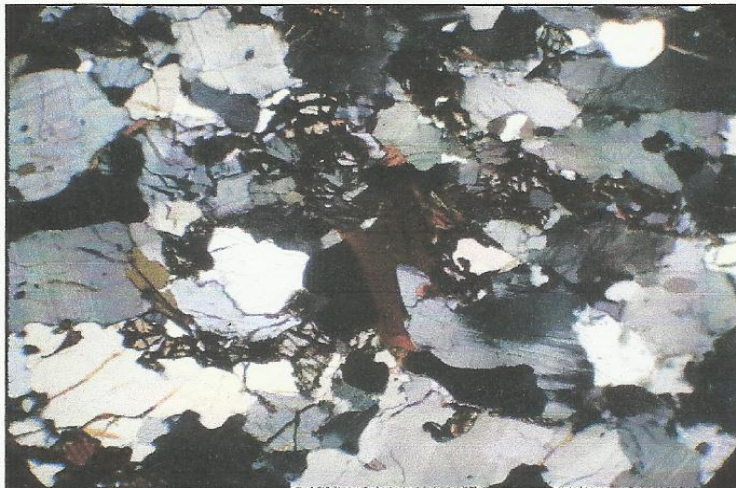
Muestra AP-2 10X/4X (NX): Se observan cristales de cuarzo (Q), plagioclasa (Pl) con maclas polisintéticas, difusas y combadas y un paquete de minerales máficos: piroxeno (Px) siendo sustituido por minerales opacos (Op) a partir de las fracturas y láminas de mica biotita (Bi).
