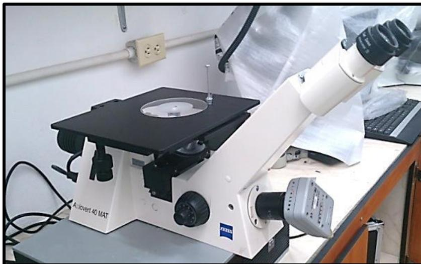
Figura 15. Microscopio óptico AXIOVERT 40 MAT , marca Carl ZEISS
