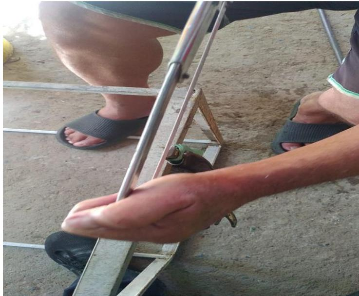
Figura 9. Proceso de corte manual de las muestras de  $Ti_6Al_4V$
