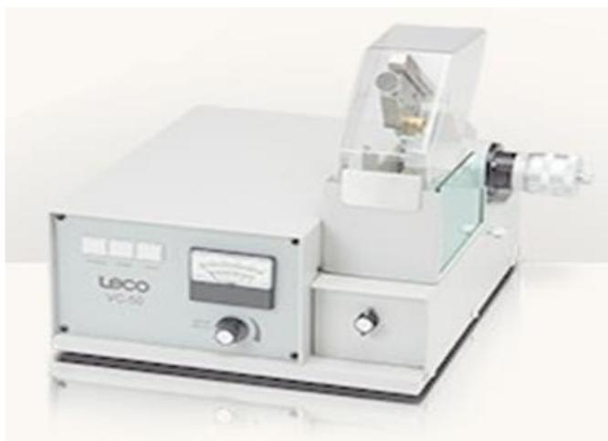
Figura 8. Cortadora abrasiva con disco de diamante marca LECO, modelo Vc-50
