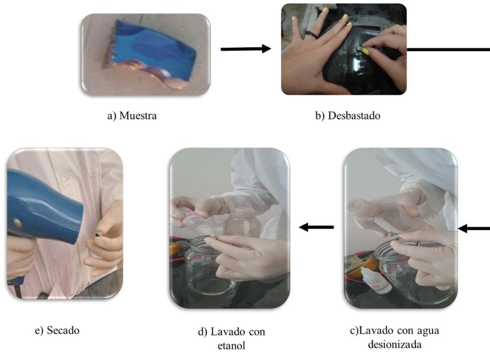
Figura 10. Esquema de preparación de las muestras  $Ti_6Al_4V$ .
