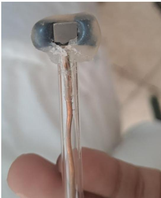
Figura 11. Electrodo de trabajo utilizado en los ensayos electroquímicos.
