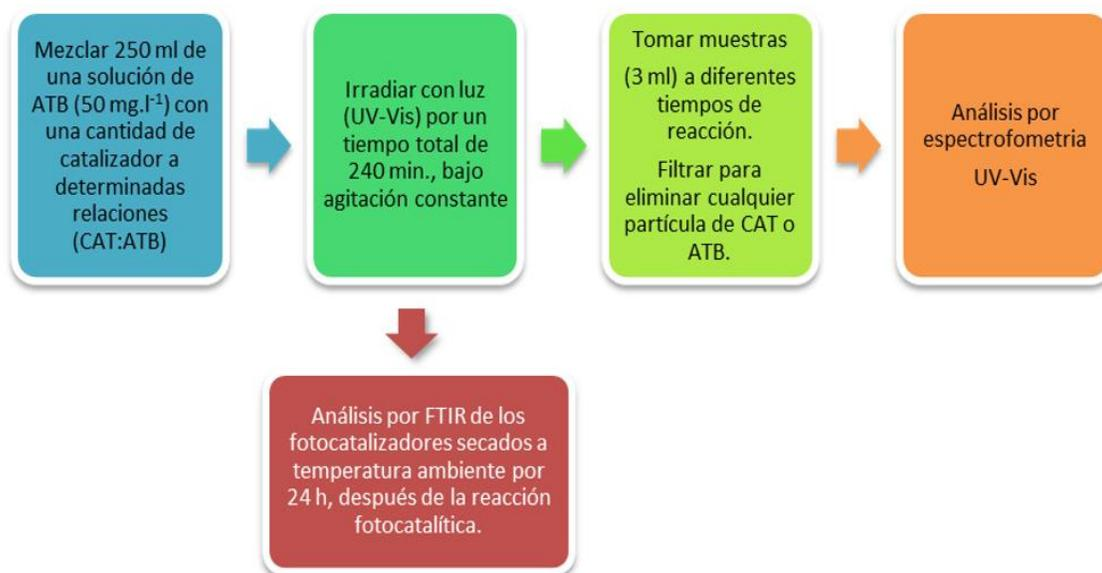
Figura 19. Esquema general del proceso fotocatalítico
