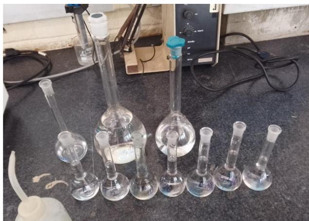
Figura 16. Soluciones patrones de ATB para la construcción de la curva de calibración
