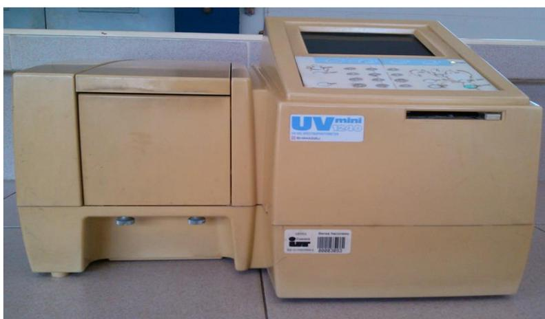
Figura 17. Espectrofotómetro UV-Vis modelo UV mini 1240 marca Shimadzu
