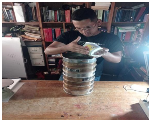
B.2 Agregando la muestra en los tamices.
