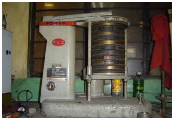
B.3 Tamizado de las muestras para el análisis granulométrico según Norma ASTM D 422.
