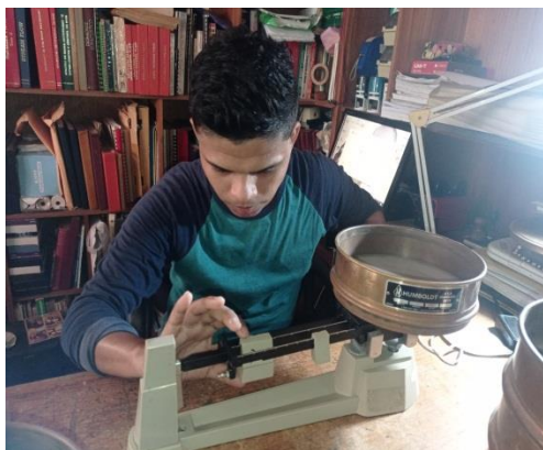
B.1 Pesaje de tamices para análisis granulométrico según Norma ASTM D 422.
