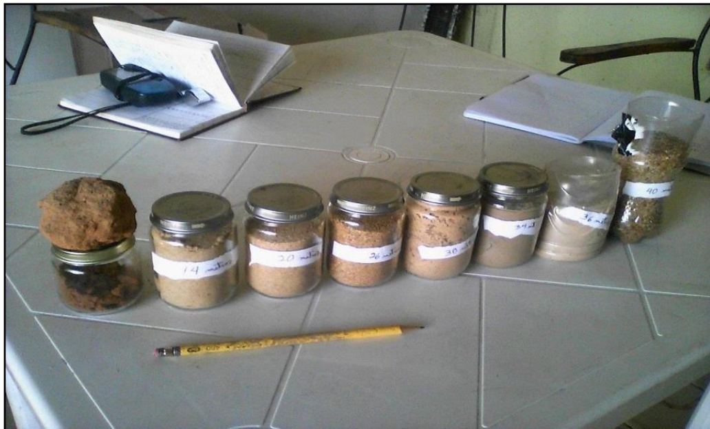
Figura 5.1 Secuencia de capas atravesadas durante la perforación del pozo. La punta del lápiz indica la cronología de depositación.
