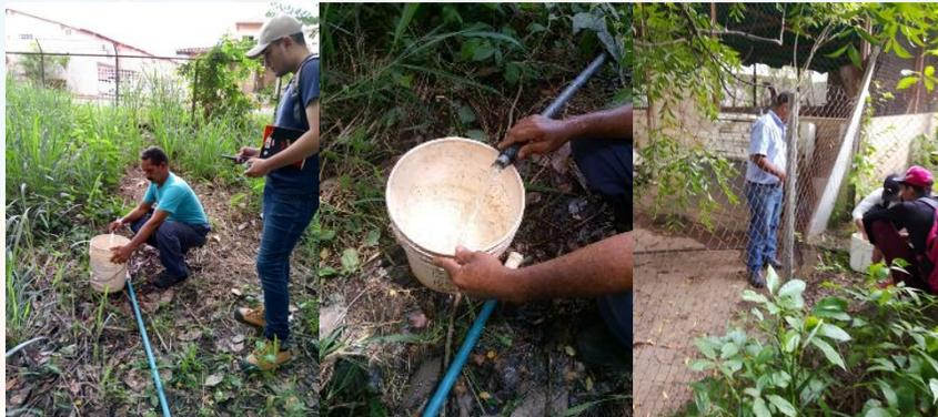
**Figura 29. Medición de caudal en los puntos de muestreo del *campus* Juanico.**
