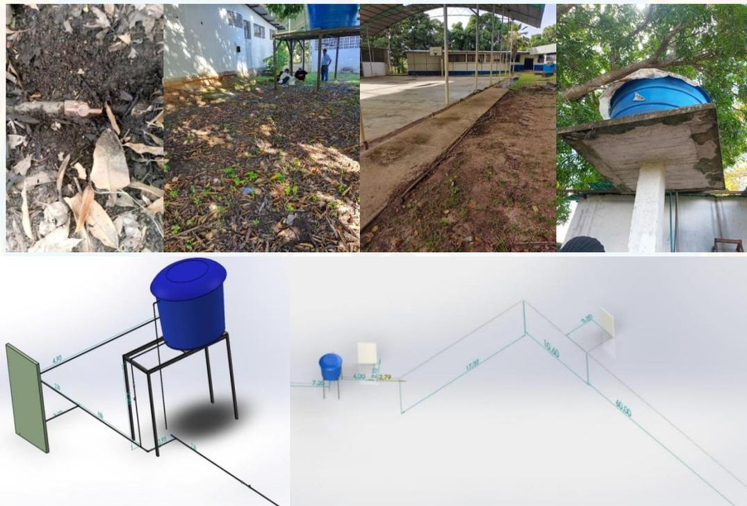
**Figura 25. Sistema hidráulico y conexión de la línea de aducción a la microestación por lado sur (F-2)**
