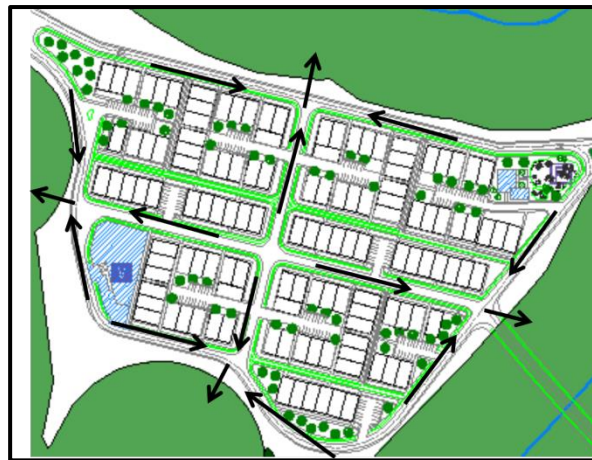
Figura 5.8 Líneas de flujo de las aguas de escorrentía.
