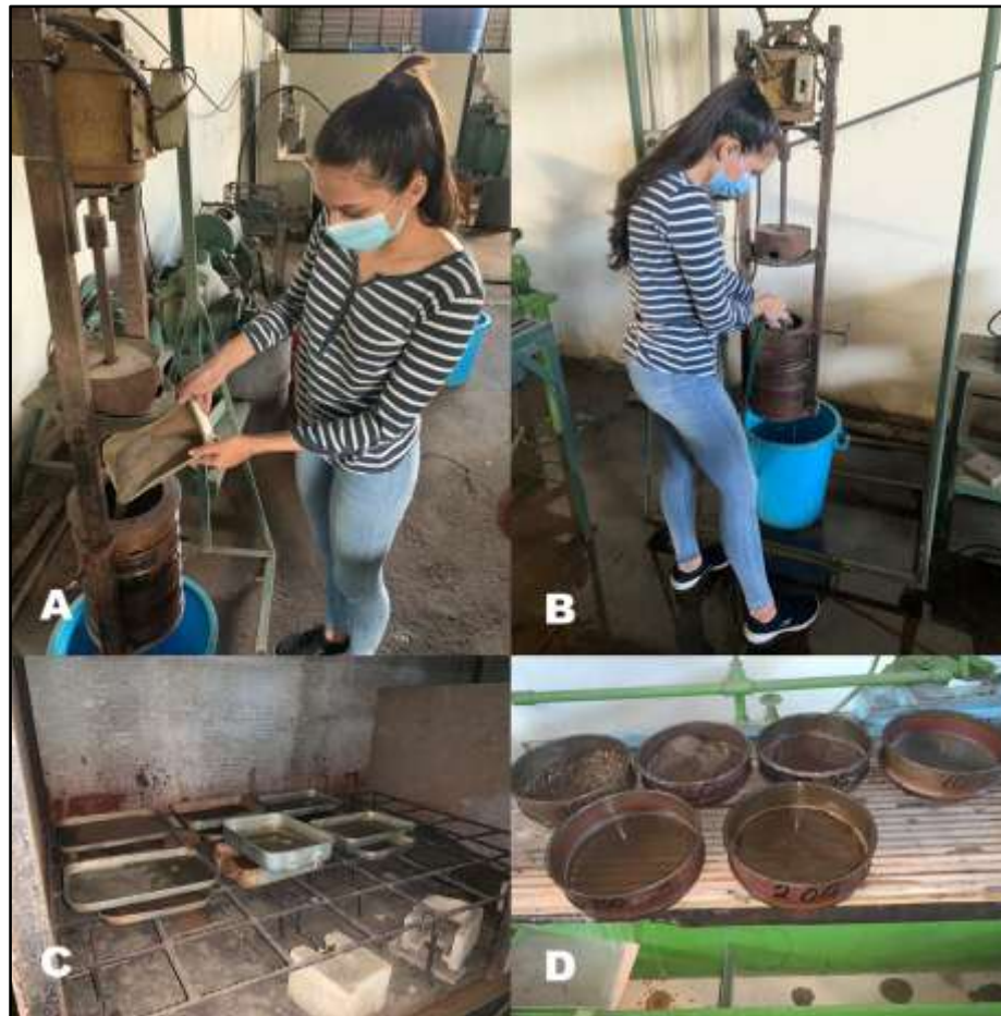
Figura 4.7 Etapa del análisis granulométrico. A tamizado de la muestra. B inyección de agua a la muestra. C muestras secándose en el horno. D material retenido en cada tamiz.
