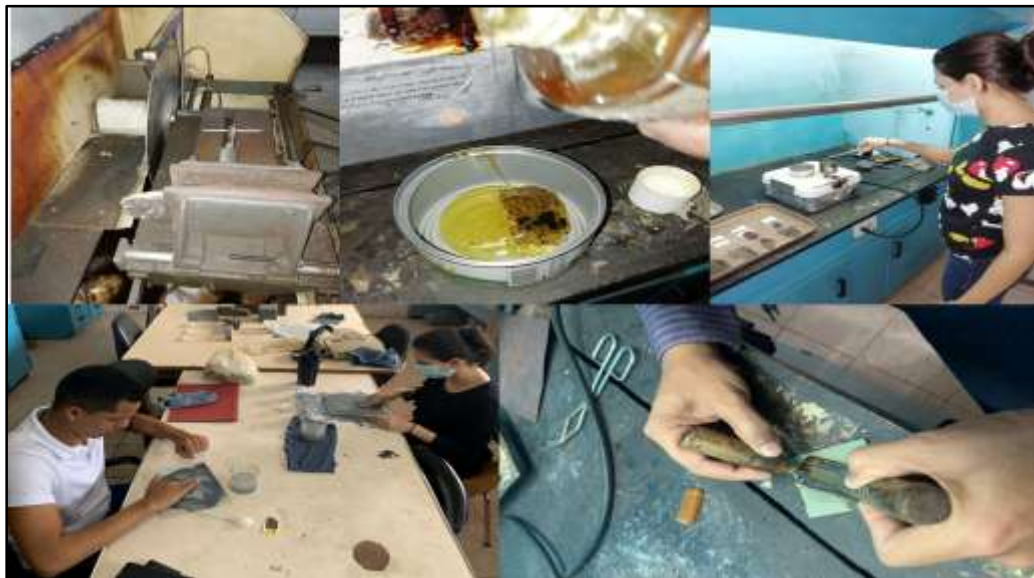
Figura 4.9 Etapas del análisis petrográfico realizado a la muestras
