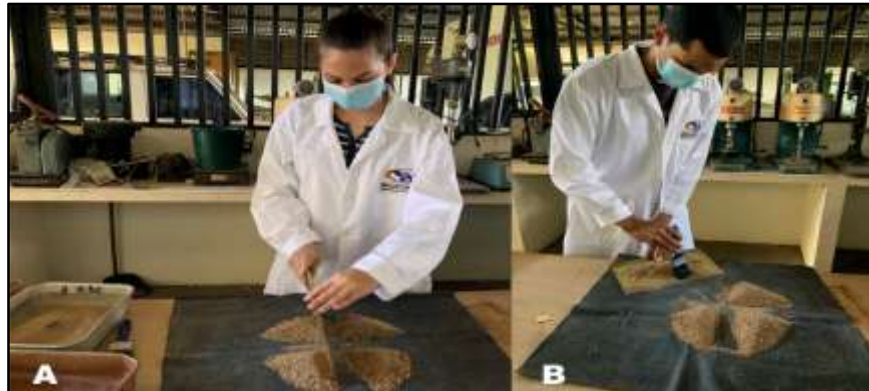
Figura 4.6 Etapa del análisis granulométrico. A cuarteado de muestra. B toma de muestra representativa del material cuarteado
