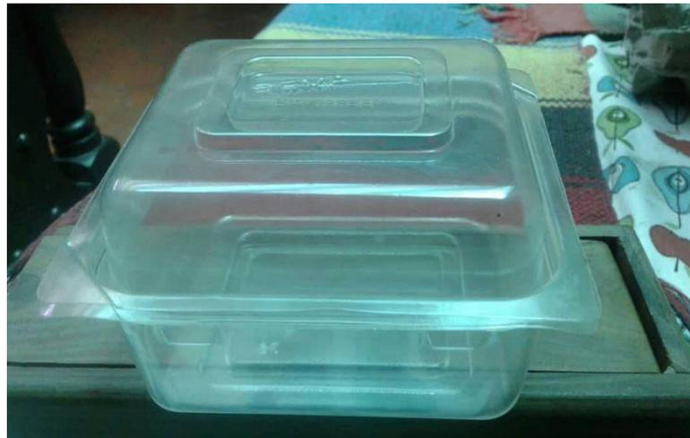
**Figura 5. Envases Phytatray Sigma producto P1552, utilizados para la siembra en sistema hidropónico de los segmentos de rizomas de cúrcuma (*Curcuma longa* L.).**
