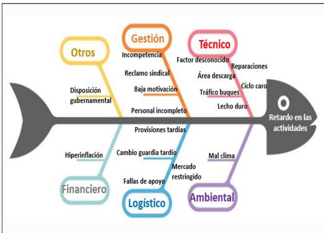
Figura 5.10 Diagrama Causa – Efecto donde se identifican los factores de riesgo.
