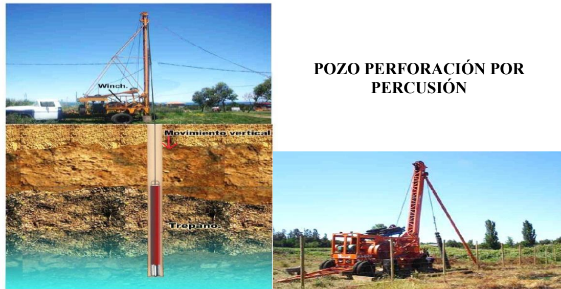
Figura 3.7. Pozo Perforación por Percusión. Fuente: (González, 2017)
