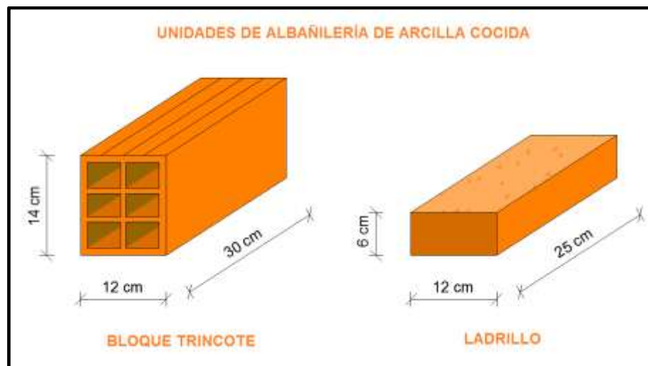
Figura 5.3 Medida de las unidades de albañilería utilizadas
