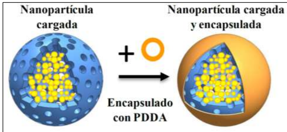
Figura 6.1 Esquema del proceso de encapsulado para las nanopartículas mesoporosas de sílice de núcleo hueco.
