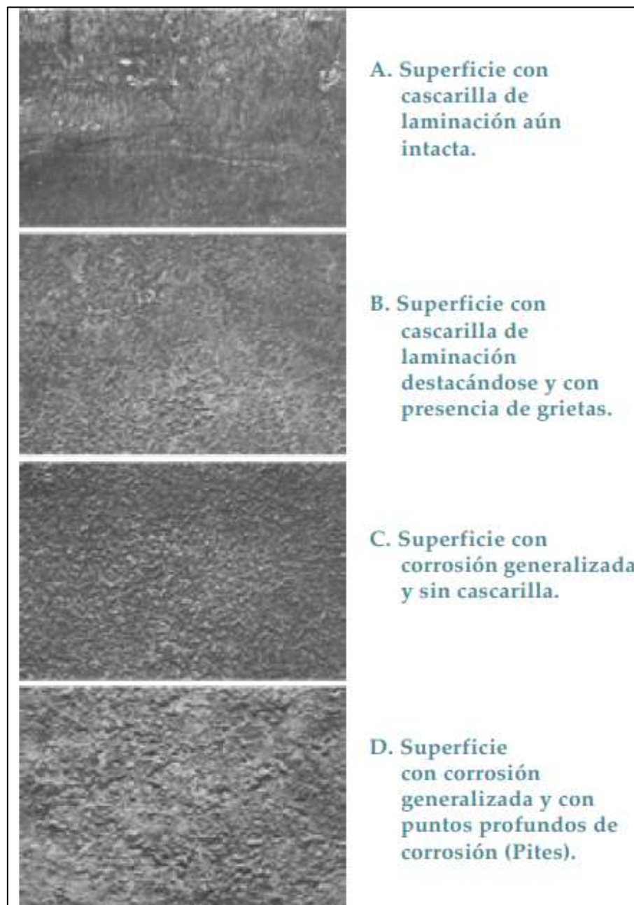
Figura B.1 Patrones de grados de corrosión (SIS 055900-1967)
