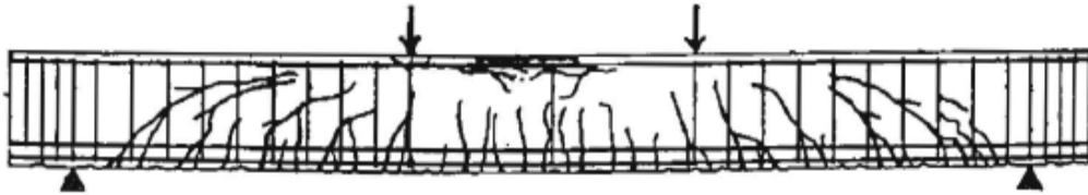
Figura 2.11 Fisuración por flexión y corte.
