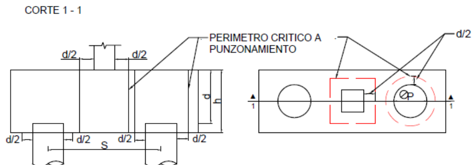
Figura 22 Punzonamiento en columnas o pilotes.
