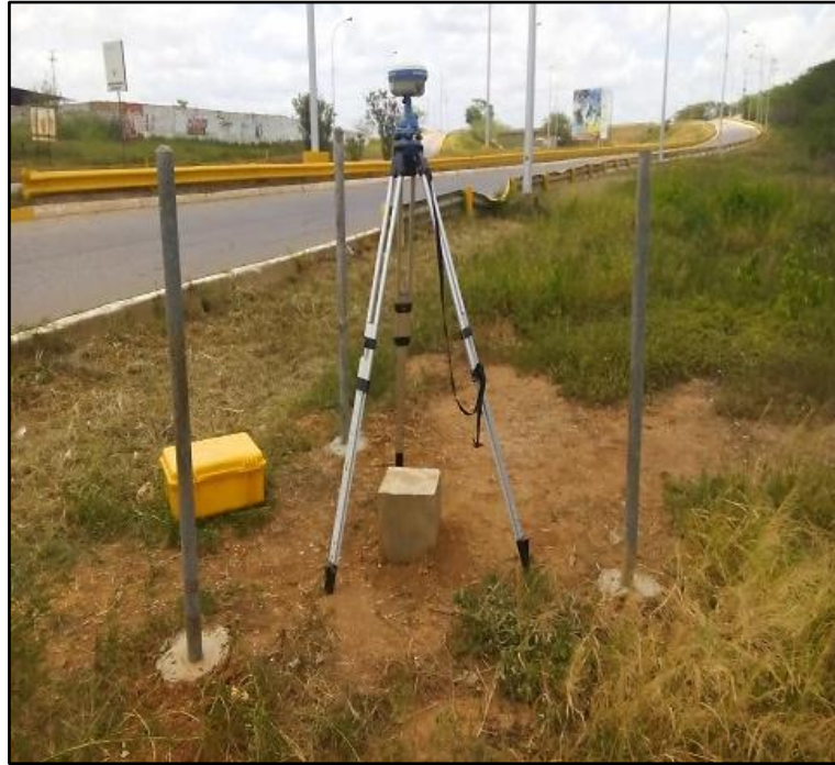
Figura 25 . Monumento de concreto de punto Cantaura2P, perteneciente a la RGM Fuente: autores (2018)
