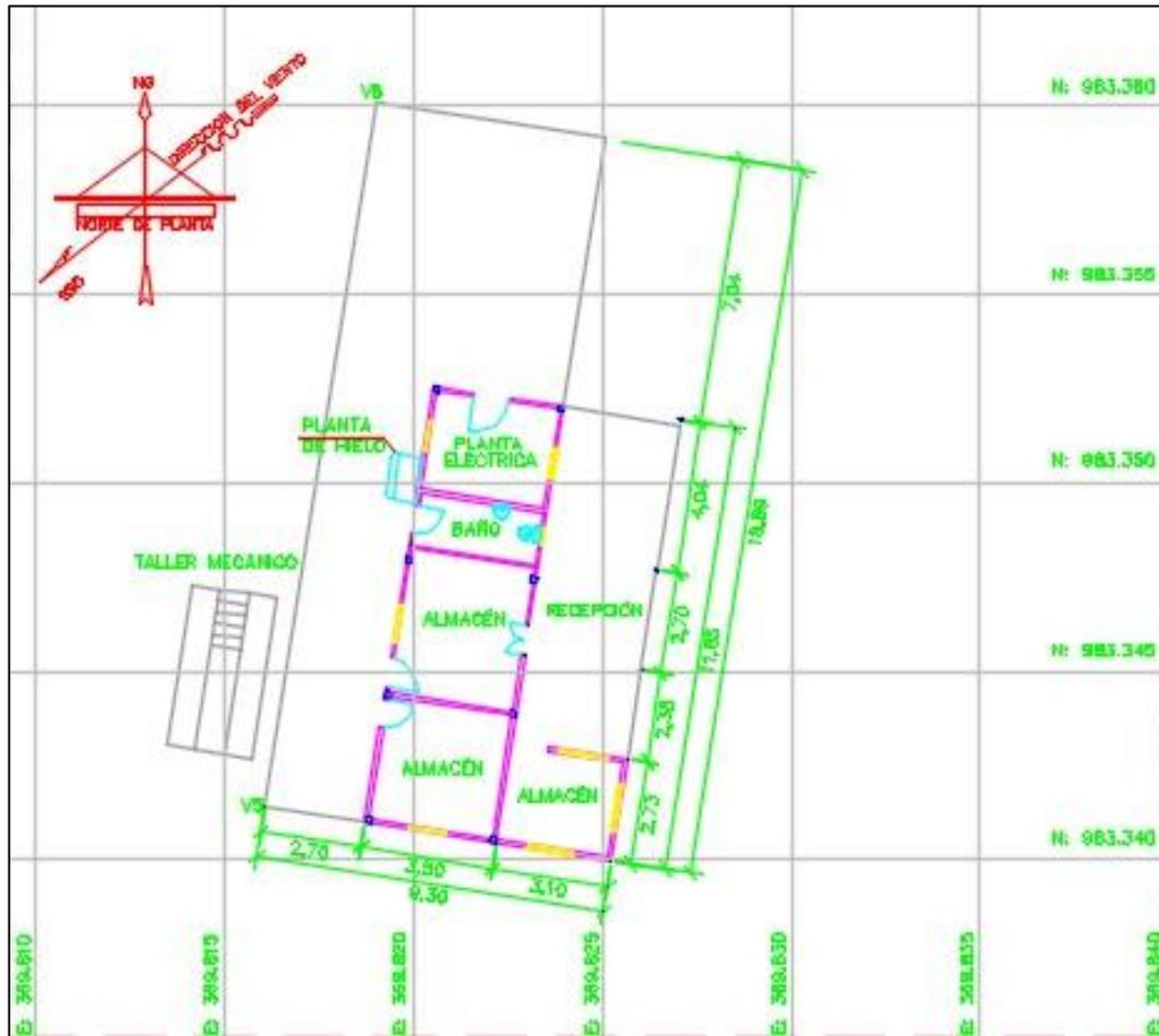
Figura 25. Levantamiento planialtimétrico del edificio de almacén y vigilancia de la empresa Constructora 3 AMG, C.A. Fuente: Autor
