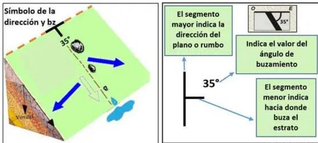
Figura 3.4 Dirección y buzamiento real de un plano geológico (Geotécnia fácil, 2024)
