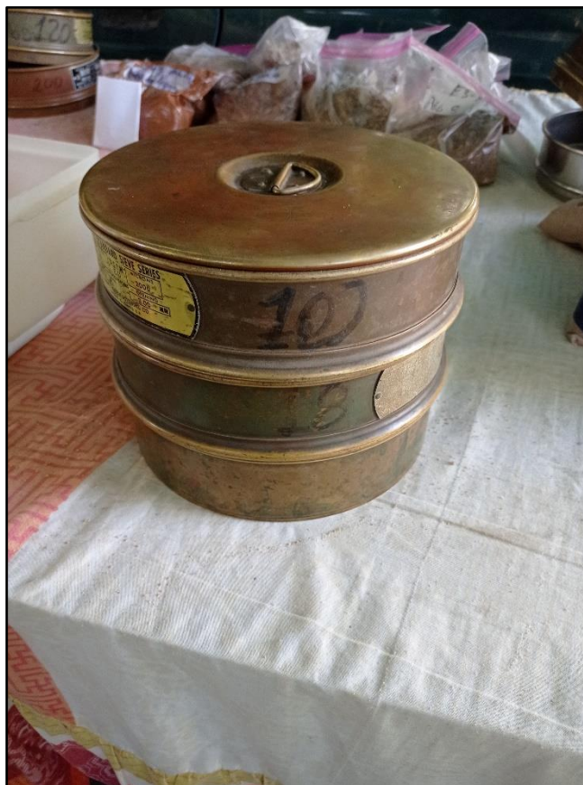
Figura 4.4 Sedimentos puestos en tamices 10, 18 y pan, previo a tamizarlas de manera mecánica.
