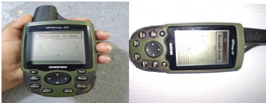
Figura 4.3 los GPS que se usaron para obtener las coordenadas UTM de la zona de interés
