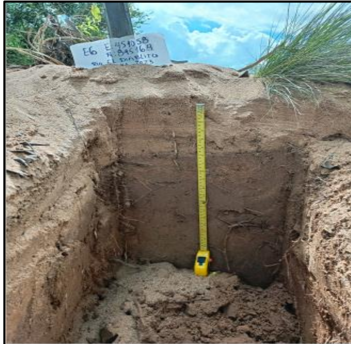
Figura 5 14: Calicata en E6
