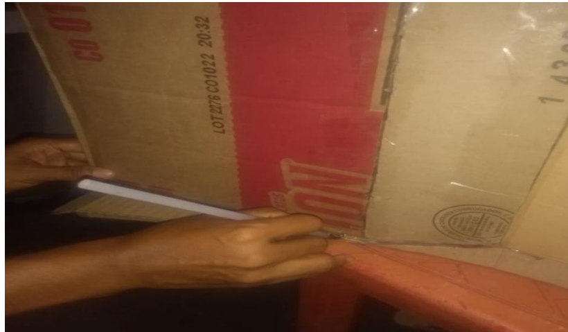
Figura 8. Pegado de piezas con silicón caliente. Fuente: Autor.
