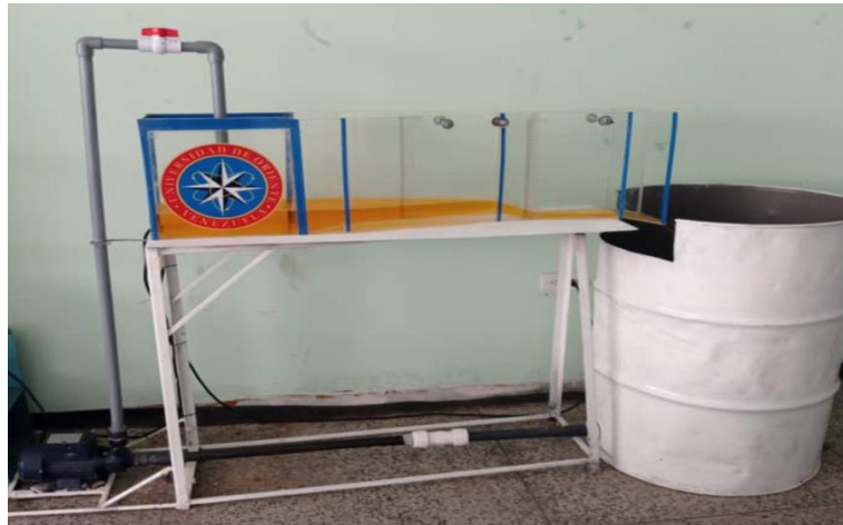
Figura 23. Canal Parshall en funcionamiento.
