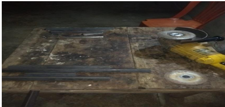
Figura 12. Corte de ángulo de hierro 1" x 1" Fuente: Autor.
