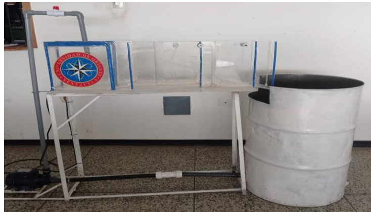
Figura 21. Instalación de la canaleta Parshall.
