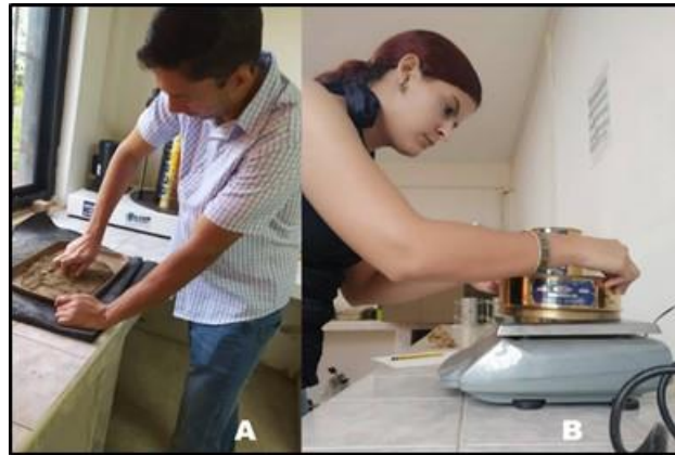
Figura 4.5 Etapa del análisis granulométrico. Homogenizado de muestra (A) y Pesado de tamiz (B)
