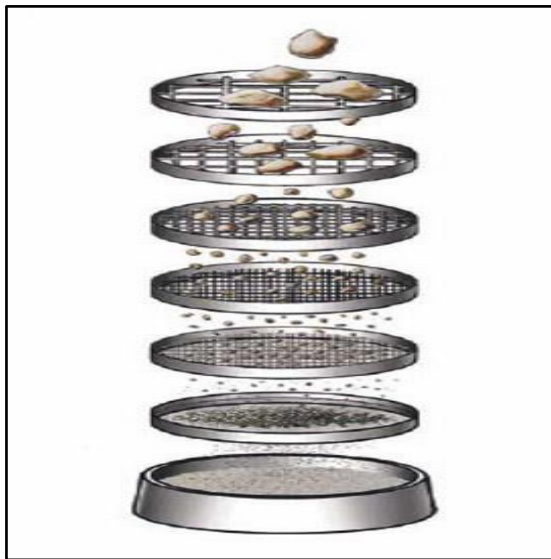
Figura 3.1. Tamizado para la clasificación de un suelo (Imagen de Google)
