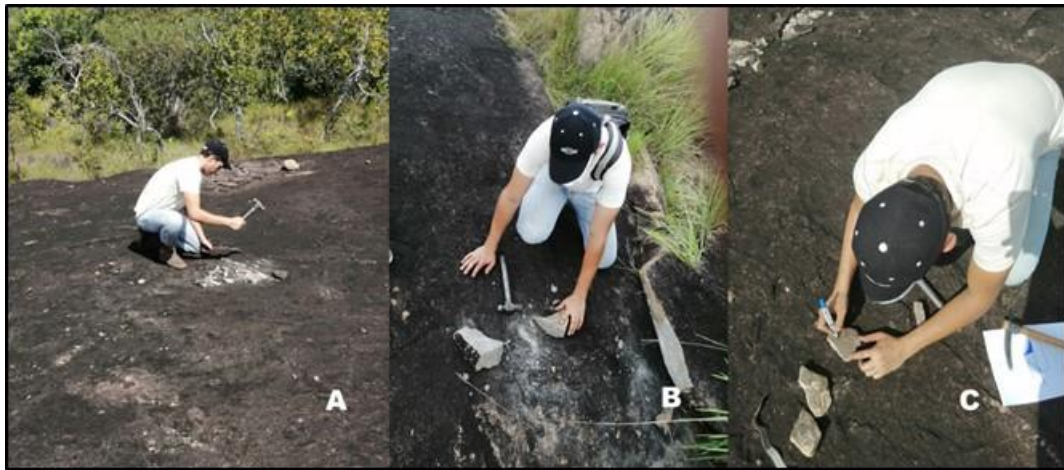
Figura 4.3 Toma de muestras de rocas de los afloramientos rocosos a nivel de superficie (A - B) y etiquetado de las muestras de roca (C).
