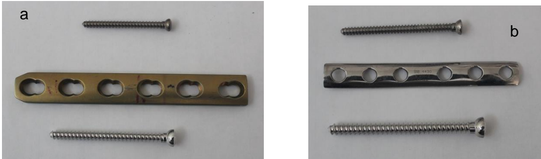
FIGURA 1: (a) Placa de Ti6Al4V y tornillos corticales de titanio y acero inoxidable (b) Placa un tercio de caña de 316L y tornillos corticales de titanio y acero inoxidable
