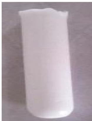
Figura 26. Apariencia física del hidrogel híbrido con 1 %  $\text{TiO}_2$  de (poli(acrilamida-co-ácido maleico)/ $\text{TiO}_2$ , sintetizado a partir de alimentar una relación de monómeros AAm/AM 80/20 con 1 % NNMBA).
