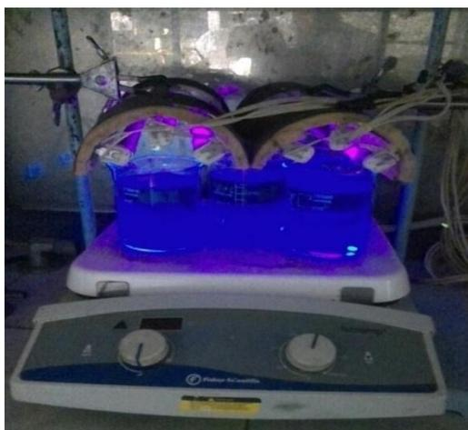
Figura 12. Reactor utilizado para la eliminación de colorante orgánico.
