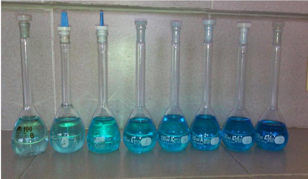
Figura 56. Soluciones patrón de azul de metileno.
