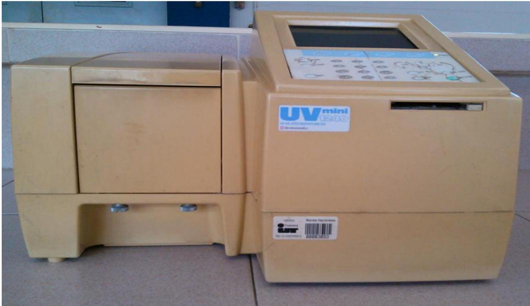
Figura 59. Espectrofotómetro UV mini 1245 marca Shimazu.
