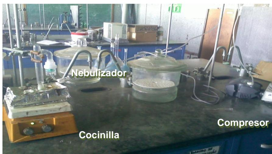
Figura 7. Montaje experimental utilizado para la síntesis.
