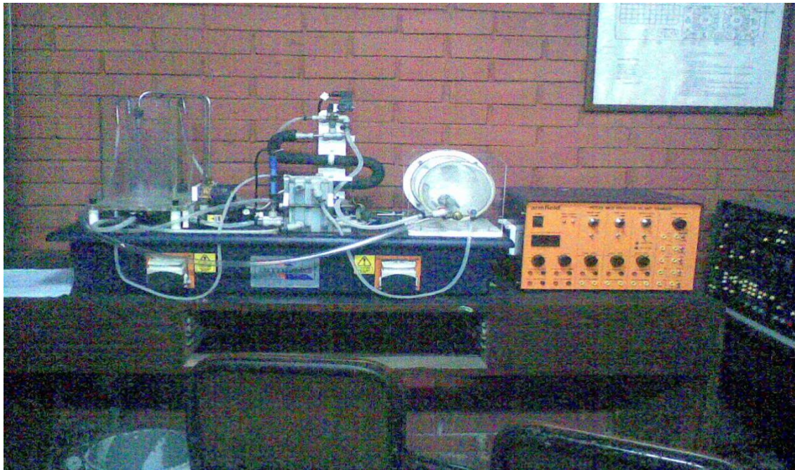
Planta Piloto de una Pasteurizadota para Control de Proceso Especifico
