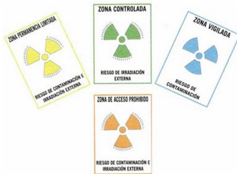
Figura 1: Señalización riesgo radiológico.
