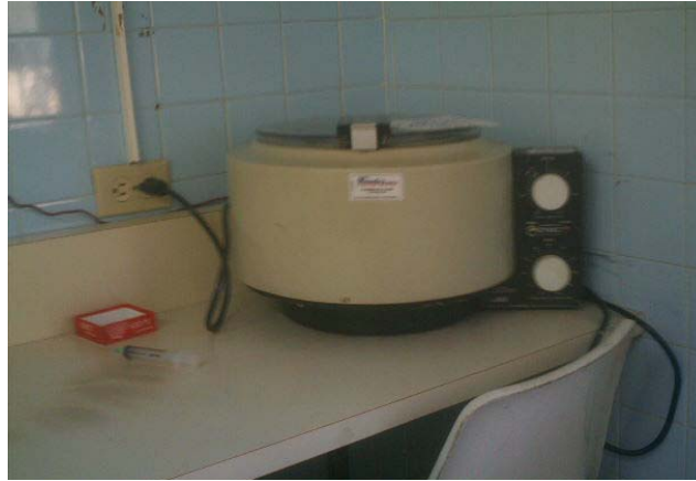
Figura 4.17. Centrifugadora con capacidad de 24 puestos Fuente: laboratorio del hospital Dr. Cesar Rodríguez Rodríguez.
