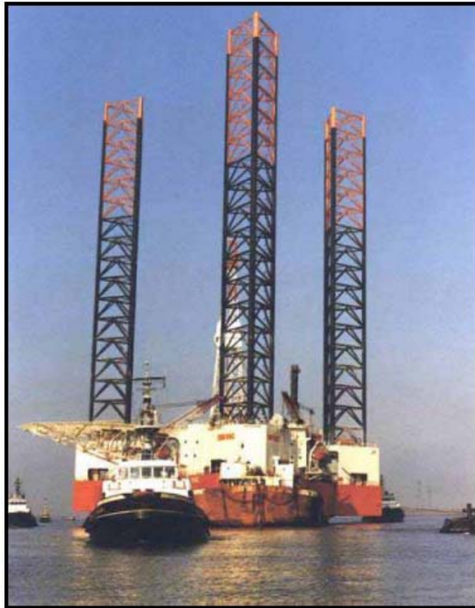
Figura 2.7 Plataforma Jack-Up Fuente: Total Professeurs Associés 2006.
