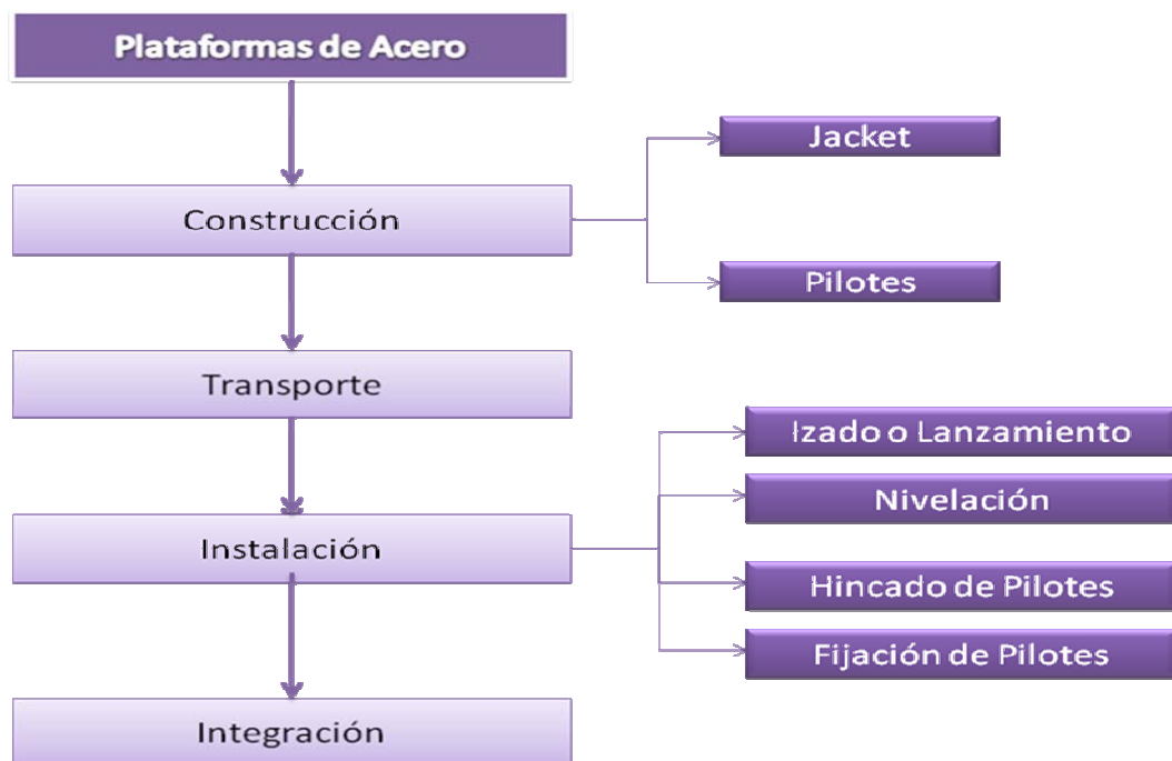
Gráfico 5.3 Diagrama de bloque de un plataforma de acero Fuente: Elaboración Propia.
