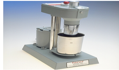
Figura, C.2. Viscosímetro rotacional, marca Fann 35A
