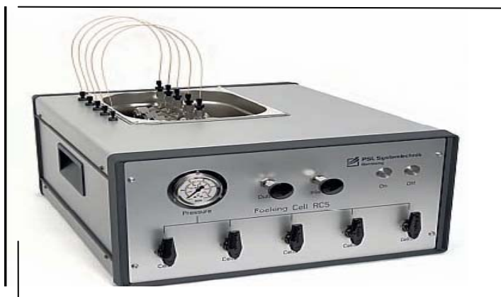
Figura 3.1 Rocking Cell RC5 equipo para analizar la formación de hidratos
