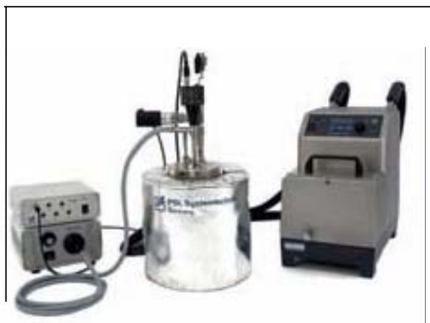
Figura 3.2 Instrumento para analizar los hidratos de gas.
