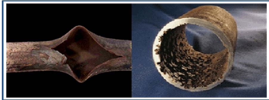
Figura 5. Corrosión en sistemas de tuberías.
