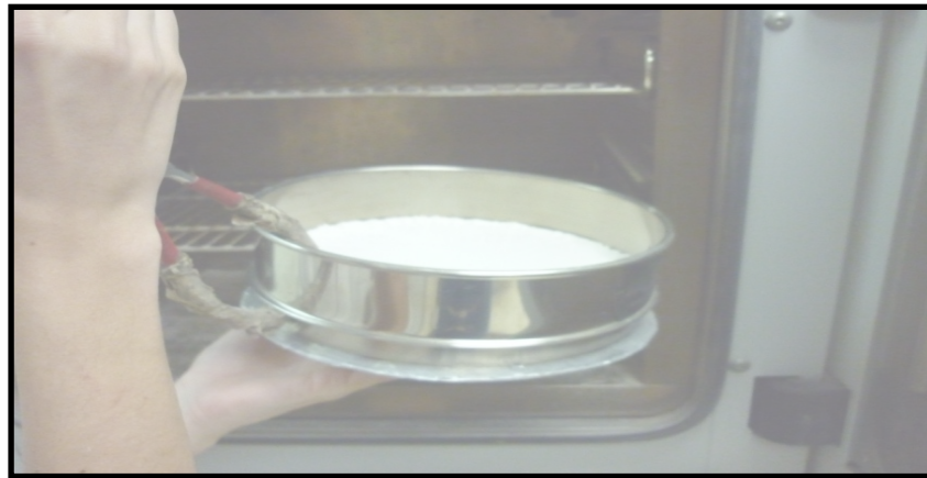
Figura 3.6 Forma de desalojar los tamices de la estufa, una vez finalizada la simulación de cocción.
