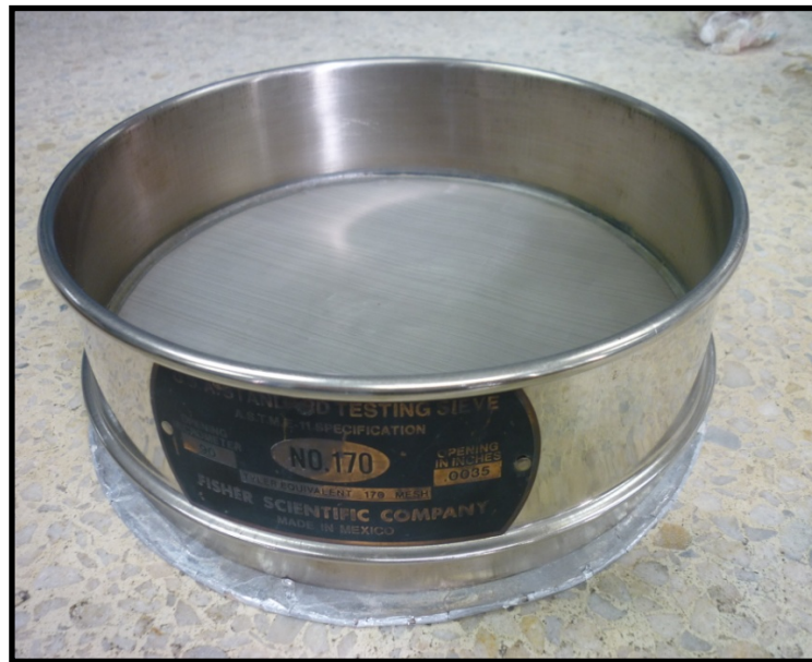
Figura 3.2 Bandeja de aluminio colocada debajo del tamiz que se emplea en la simulación de la cocción.
