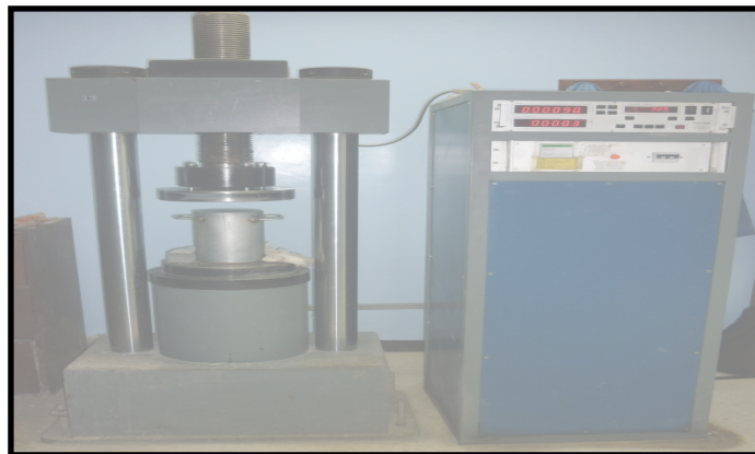
Figura 3.10 Prensa hidráulica empleada como máquina de prueba en el ensayo de resistencia a la compresión del yeso.
