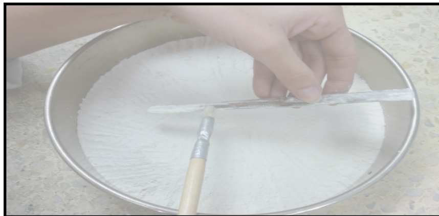
Figura 3.4 Procedimiento de compactación del yeso crudo en el tamiz para la simulación de la cocción.
