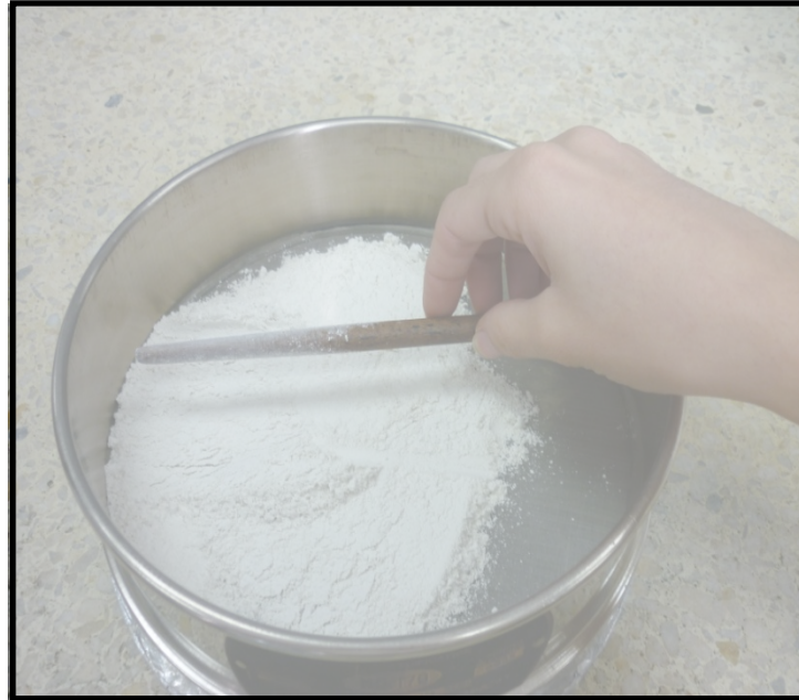
Figura 3.3 Forma de extender el yeso en el tamiz para realizar la simulación de la cocción.
