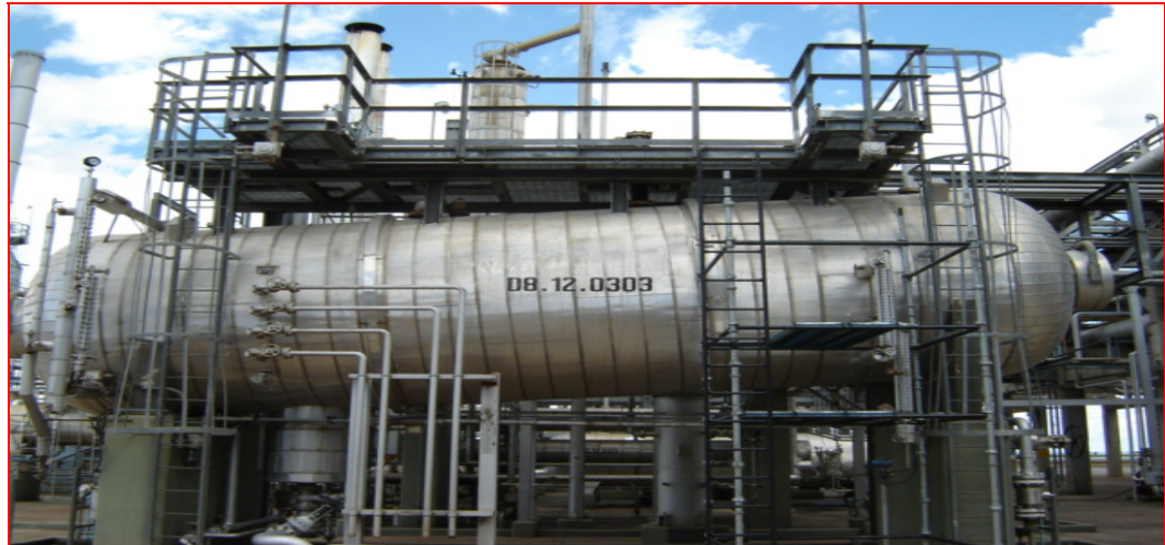
Figura 4.2 Desafaltenizador presente en el proceso de regeneración del Glicol.
