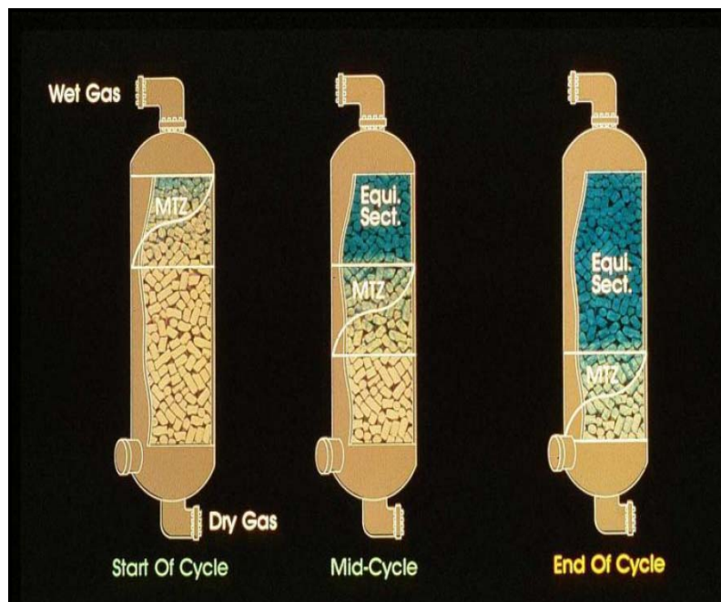
Figura 4.16 Zonas de transferencia de masa de un tamiz.
