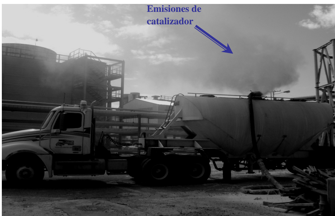
FIGURA 4.5 Camión recolector de catalizador gastado, para ser retirado de la planta.
